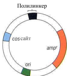
Рис. 2. Структура типичного космидного вектора, объединяющего свойства фага \lambda и плазмиды.
